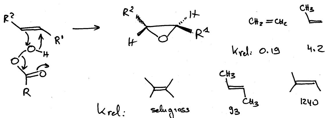
Epoxidierungsaktivität:  $\text{CF}_3\text{CO}_3\text{H} > \text{HCO}_3\text{H} > \text{C}_6\text{H}_5\text{CO}_3\text{H} > \text{CH}_3\text{CO}_3\text{H}$
